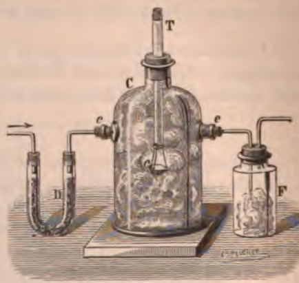
Fig. 27. Combustion du phosphore dans l'oxygène.
